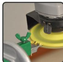
Cuchilla de acero para recortar el respaldo de los discos laminados.
