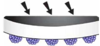
Pula los primero 45 seg. a 1000 RPM ejerciendo cierta presión sobre la máquina, para poder fragmentar el grano abrasivo, ya que durante este periodo se realiza un corte rápido.
