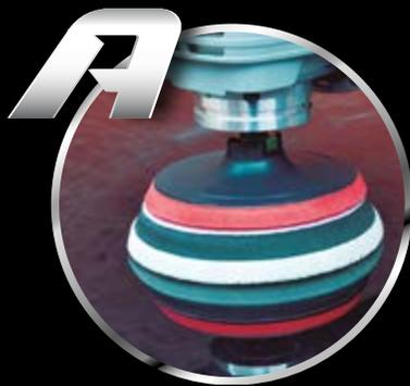
**A** Coloque el respaldo con sistema de fijación **CULTRAGRIP** de acuerdo al tipo de máquina (rosca 5/8"-11H o rosca M14-2) en su pulidora de pinturas. Monte el bonete
